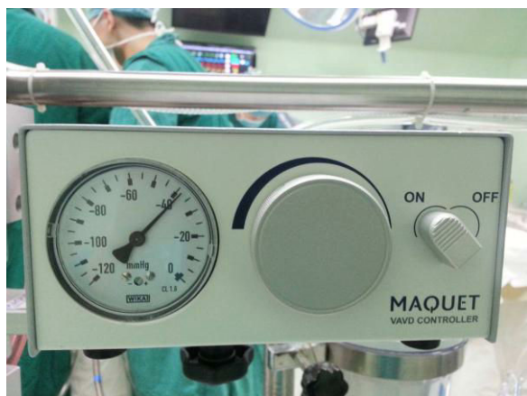
图 1. Maquet 负压辅助静脉引流系统
